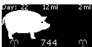
Nach dem Laden ist das Gerät bereit zum Impfen. Dies wird durch eine **weiß blinkende LED** und laufende Ferkel auf dem Display dargestellt. In dieser Phase kann (a) der erste Injektionszyklus gestartet werden, (b) ein weiterer Spülzyklus durchgeführt werden oder (c) der Stallzähler bzw. die Füllstandwarnung zurückgesetzt werden.
