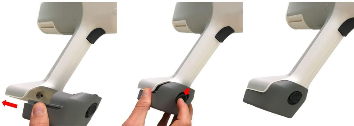
Ein Befestigungsknopf hält den Akku an der richtigen Stelle. Der Akku kann durch Herunterdrücken des Knopfes und durch Herausziehen des Akkus vom Gerät entfernt werden.
