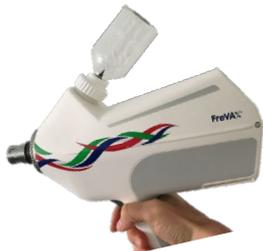
**Bitte bewegen Sie das Gerät nicht aus seiner vertikalen Position (siehe Bild links) bis es vollständig geladen ist (weiße LEDs leuchten auf).**
