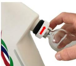
e. Schließen Sie die Flasche an das Gerät an, indem Sie den Flaschenadapter (im Uhrzeigersinn) auf das Gewinde schrauben bis es fest sitzt. Bitte drehen Sie dabei nur den weißen Flaschenadapter, nicht die Flasche selbst. Überprüfen Sie anschließend ob die Flasche fest sitzt.
