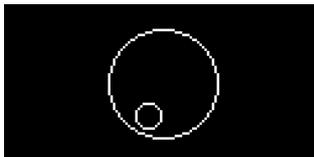
Wenn das FreVAX™ Gerät in der richtigen Position gehalten wird, befindet sich der kleine Kreis innerhalb des großen Kreises und das Gerät beginnt, Flüssigkeit einzuziehen. Diese Funktion hilft das Risiko zu verringern, dass Luft in das System eingesaugt wird.
