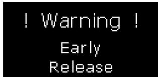
Darüber hinaus misst der Düsensensor, ob die Mindestkontaktzeit zwischen Gerät und Ferkel für die **Verabreichung der vollen Dosis** erreicht wurde. Wird der Injektor zu früh vom Tier entfernt, was eine Unterdosierung indiziert, gibt das Gerät eine optische Warnung über rot blinkende LED-Balken und eine schriftliche Meldung auf dem Display aus.
