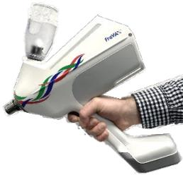
e. Drehen Sie den Injektor wieder in eine aufrechte Position. Legen Sie den Akku unterhalb des Griffs ein. Dieser Schritt aktiviert das Gerät.
