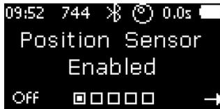
Auf der ersten Seite des Untermenüs kann der Positionssensor gesteuert werden. Drücken Sie die linke Displaytaste um den Positionssensor zu deaktivieren oder zu aktivieren. Es wird ein aktivierter Positionssensor empfohlen ("Position Sensor enabled"). (Das Deaktivieren wird nur empfohlen, wenn Sie den mitgelieferten Schlauchadapter verwenden). Weitere Einzelheiten finden Sie im Kapitel 8 "Sensoren".
