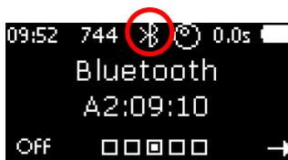
Auf der dritten Seite kann Bluetooth gesteuert werden. Drücken Sie die linke Displaytaste, um die Bluetooth-Antenne zu deaktivieren oder zu aktivieren. Für die Verwendung der FreVAX™ App ist das Aktivieren der Bluetooth-Schnittstelle erforderlich. Wenn die FreVAX™ App nicht verwendet wird, wird die Deaktivierung der Bluetooth-Schnittstelle empfohlen, um den Akku zu schonen.
