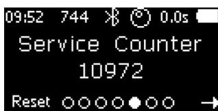
Die fünfte Seite zeigt den Servicezähler, welcher von 12.000 auf 0 abwärts zählt. Fällt der Zähler unter 0 wird im Negativbereich weitergezählt. Halten Sie die linke Displaytaste zwei (2) Sekunden lang gedrückt um diesen Zähler zurückzusetzen.
