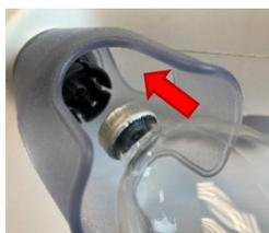
d. Stechen Sie den Gummistopfen der Impstoffflasche mit einer sterilen Nadel in der Mitte vor, um zu verhindern, dass Gummipartikel in den Ansaugdorn des Impfgeräts gezogen werden und um den Überdruck im Inneren der Flasche zu entfernen. Stellen Sie den Injektor auf einen festen Untergrund (wie auf dem ersten Bild gezeigt) und drücken Sie die Flasche mit dem vorgestochenen Loch auf den Ansaugdorn.
