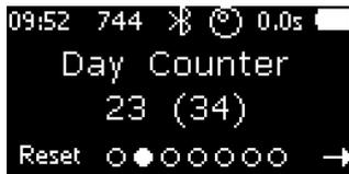
Auf der zweiten Seite wird der Day Counter (Tageszähler) angezeigt. Halten Sie die linke Displaytaste zwei (2) Sekunden lang gedrückt um diesen Zähler zurückzusetzen.
